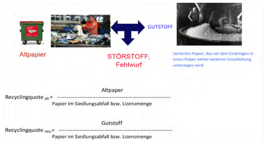
Abb. 14: Recyclingquote für Altpapier nach der alten und der neuen Berechnungsmethode Quelle: Vgl. DURCHFÜHRUNGSBESCHLUSS (EU) 2019/1004 DER KOMMISSION vom 7. Juni 2019 zur Festlegung der Vorschriften für die Berechnung, die Prüfung und die Übermittlung von Daten über Abfälle gemäß der Richtlinie 2008/98/EG des Europäischen Parlaments und des Rates sowie zur Aufhebung des Durchführungsbeschlusses C(2012) 2384 der Kommission (Bekannt gegeben unter Aktenzeichen C(2019) 4114) ANHANG I BERECHNUNGSPUNKTE GEMÄSS ARTIKEL 3 ABSATZ 2
